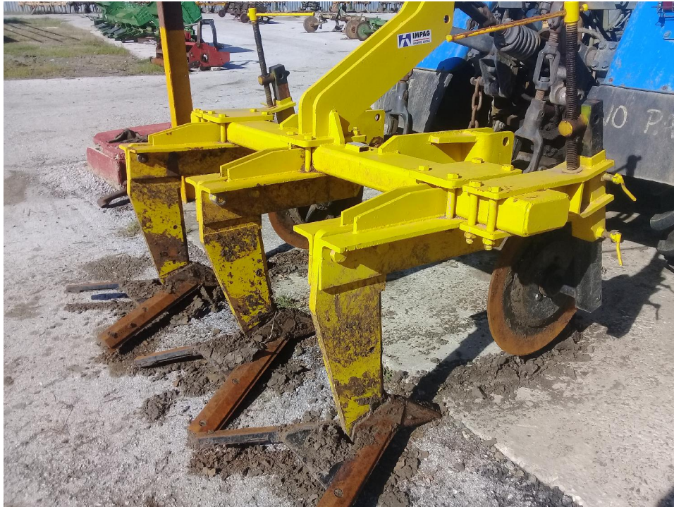
Figura 3.3. Multiarado IMPAG M/98 acoplado a tractor XTZ – 150K – 09.
