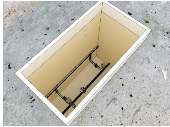
Figura A.2 Vista superior del nicho donde se ubican los instrumentos.
