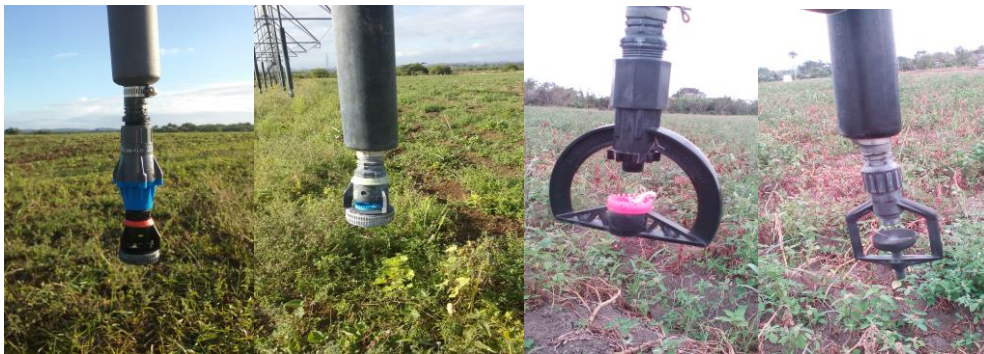
Figura 10. Sustitución de boquillas en el tramo 3
