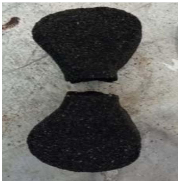
Figura 4: Probeta rota después del ensayo de tracción.
