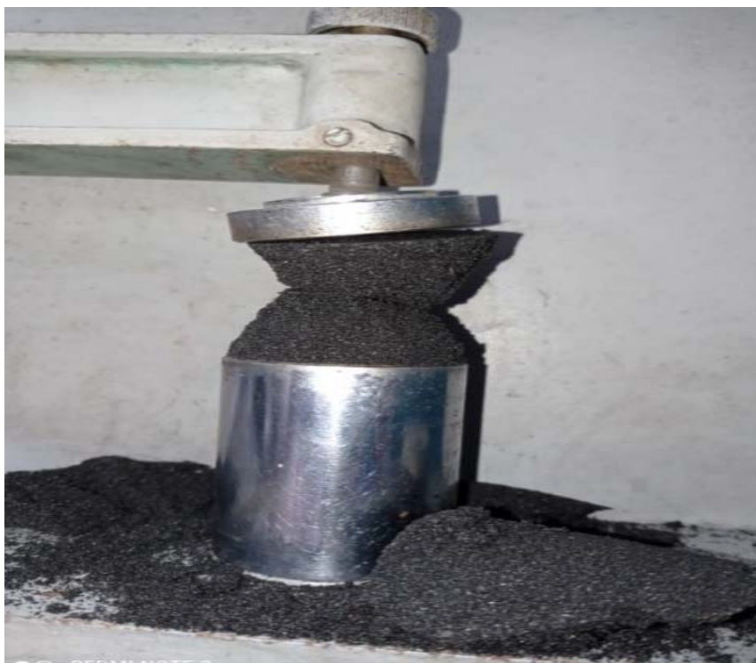
Figura 5: Probeta rota después del ensayo de compresión.
