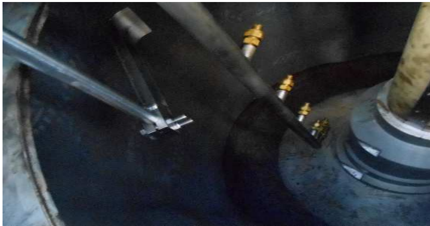
Figura 3. Se observa de izquierda a derecha: la paleta del palpador, el spray de lavado y el cono de descarga
