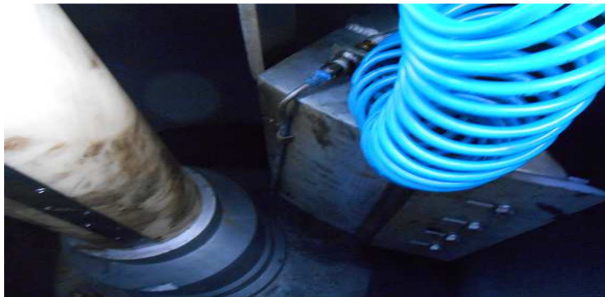
Figura 4. Se observa de izquierda a derecha: el cono de descarga y el arado
