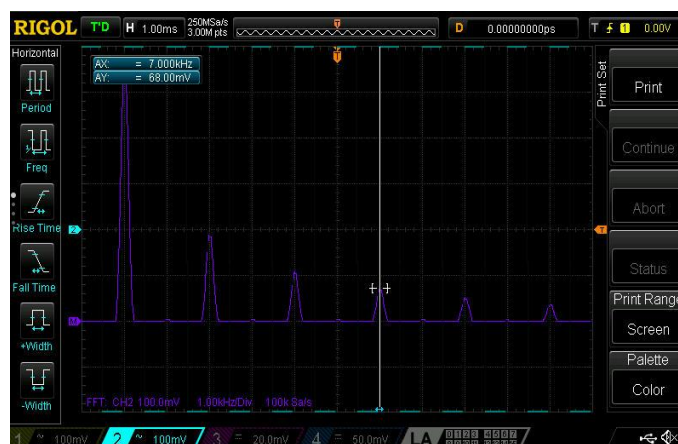
Figura 3.4: Componentes armónicos de la señal amplificada
