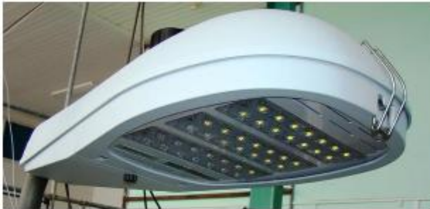
Fig. 2.12 Luminaria LED en proceso de prueba.
