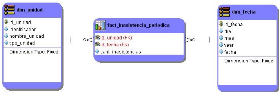
Fig. A. 6 Esquema estrella para el subproceso de registro de inasistencia a nivel periódica
