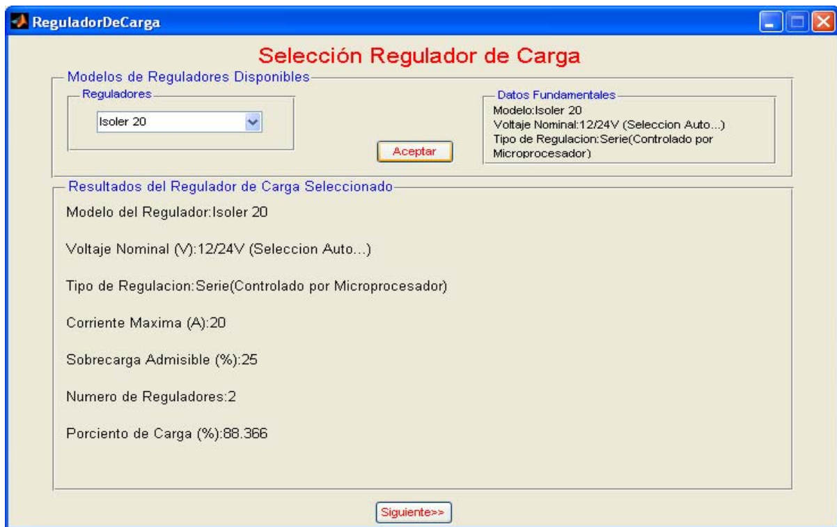
Figura 3.5. Cálculo del regulador de carga
