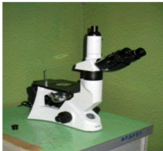
Figura 2.3 Foto de microscopio utilizado durante el ensayo metalográfico.
