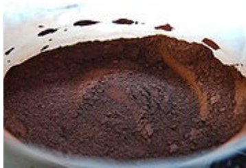
Figura 1.1: Mezcla de termita usando óxido de hierro (III)
