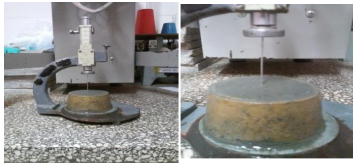
Figura 2.8: Equipo Vicat, medición de Tiempo de fraguado con la aguja de 1mm
