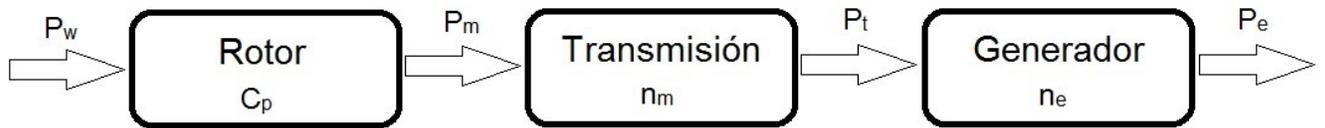
Figura 2. 2 Secuencia de los rendimientos y potencias de los componentes del aerogenerador.
