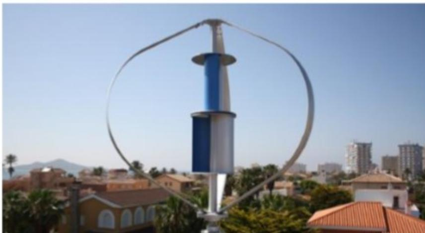
Figura 1. 11 Aerogenerador híbrido.
