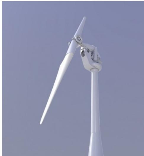
Figura 1. 5 Aerogenerador monopala.
