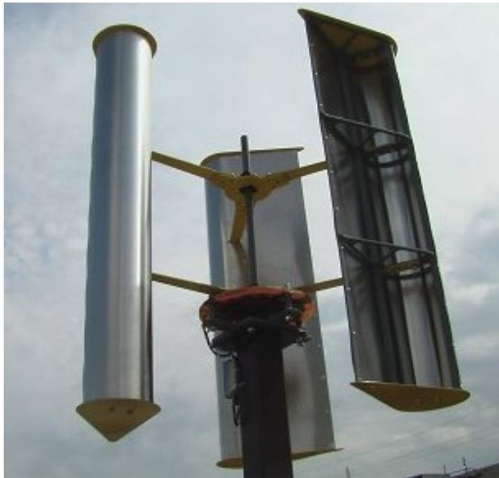
Figura 1. 15 Aerogenerador Lenz II.
