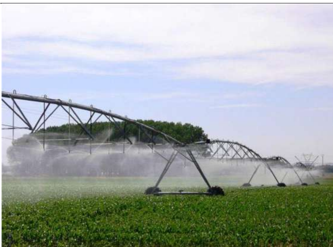
Figura 1. Máquina de riego pivote central eléctrica.
